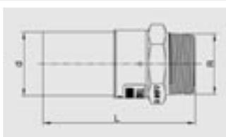
Компактное изделие. Полиэтиленовая часть дает возможность производить монтаж вне зависимости от длины и обеспечивает герметичное сварное соединение со всеми подходящими фасонными изделиями FRIALEN® независимо от положения детали. Латунная часть неразрывно связана с полиэтиленовой. Не поддается деформации.
