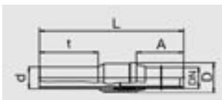
Компактное изделие. Часть ПЭ-ВП для приваривания FRIALEN®-муфт типа MB и UB без специальных держателей и приспособлений. Стальная часть неразъемная и надежно закреплена от прокручивания в ПЭ-ВП. Самоуплотняющаяся запатентованная геометрия уплотнения **без эластомерного уплотнения**. Небольшой расход изоляции благодаря нанесенной защитной трубе. Для применения в области газоснабжения. Стальной патрубков с маркировкой (для давления газа до 10 бар).
